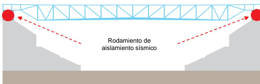
Visión general del área de montaje del rodamiento de aislamiento sísmico
